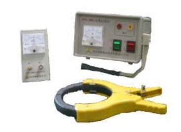
DSY—2000 电缆识别仪是 DSY 电缆识别仪的第三代产品,它总结并克服了第一代霍尔感应单点接触式识别仪(DSY-9)只能判断大小而不能判断方向的缺陷,同时克服了第二代 U 型插槽式识别仪(DSY-1000)的因漏磁而影响识别的缺陷。由于有了方向及大小的双重判别使得 DSY—2000 型电缆识别仪的识别正确率达到了 100%。
